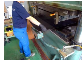
③ 樹脂を混ぜてプレスし「PANECO」へ
